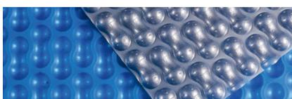
**Sommerabdeckung Geo Bubble:** Keine Sicherheitsabdeckung. UV-stabilisierte Luftpolsterfolie 400 µm aus Polyethylen. Oberseite dunkelblau, Unterseite schwarz. Hemmt deutlich das Algenwachstum, absorbiert die Sonnenenergie und verringert den Chemikalien-, Energie- und Wasserverbrauch.
